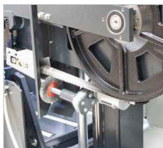
Escova de remoção de limalhas acionada eletricamente
